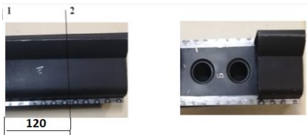
Схема №1 Удаление части панели
