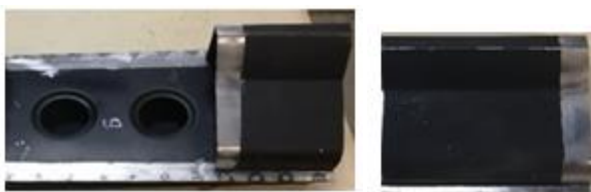
Рис. 2. Вырез поврежденного участка и ремонтная вставка АЗ
